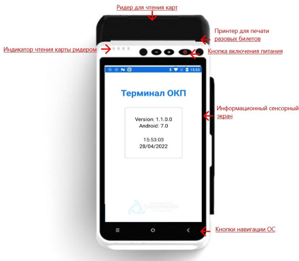
Рисунок 1. Основные элементы терминала ОКП
