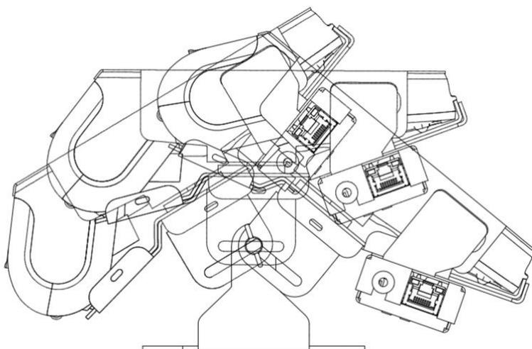
Рисунок 3 — Варианты расположения POS-терминала
